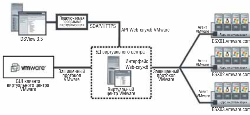
Рисунок 2. Интеграция управляющего ПО Avocent DSView компании Emerson Network Power со средствами управления VMware для организации унифицированного доступа персонала ИТ к виртуальным и физическим ресурсам.
